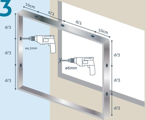
**COLOQUE EL MARCO:** Márquelo previamente y perfórelo utilizando broca de 4,5mm., según esquema. Para perforar el vano utilice broca de concreto de 6mm. El marco debe entrar libremente.
